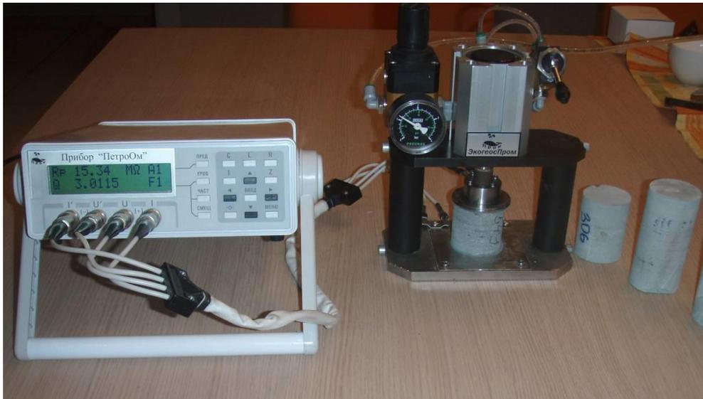
Рис.4.2. Аппаратура для измерения УЭС образцов ГП – «ПетроОм».
