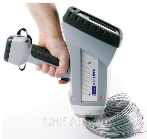
*Рис.4.4. Портативный рентгенофлуоресцентный анализатор химического состава.*
