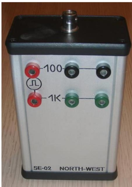
*Рис.4.3. Лабораторный генератор тока SE-02.*
